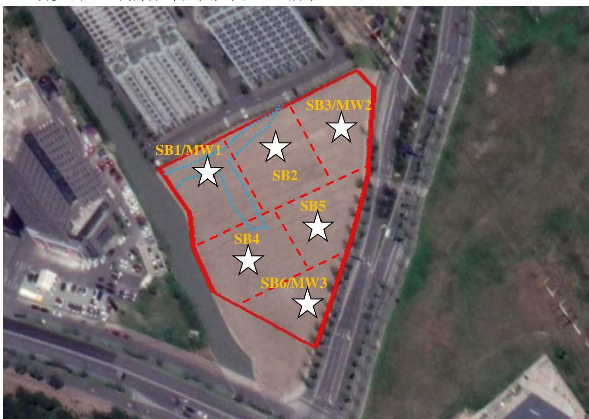
图 4.1-1a 初步调查监测方案布点图 a（蓝色虚线区域为原小河所在区域）
